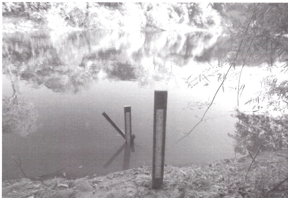
Nova Seção de Réguas da Elevatória Tupambaé
