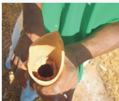
Figuras 21, 22 e 23 – Incrustação devido a presença de carbonatos em tubulação de poços
